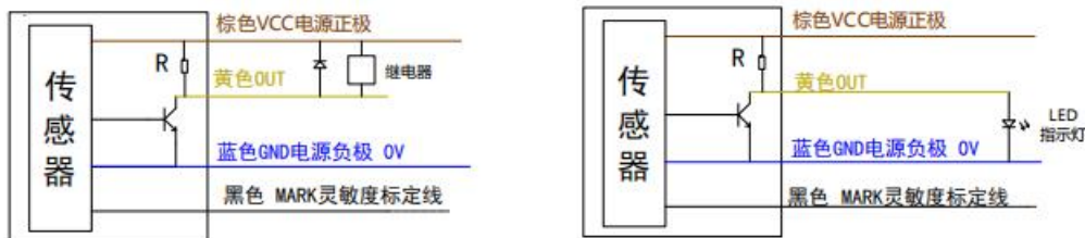
高低电平信号输出：连接继电器的接线方法
